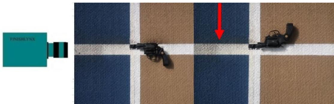
El sensor (tester), debe situarse junto a la pistola, en un lugar próximo (5-10 cm), pero evitando que se pueda quemar. Incluso una distancia superior, suele ser suficiente. Si se dispone de ella, es recomendable utilizar alguna placa de protección debajo de la pistola para evitar que el fogonazo de la pistola deje una marca en la pintura de la línea de meta.
